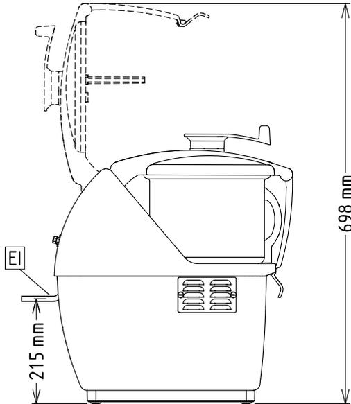
EI = Conexión eléctrica (energía)
